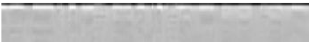
Image 10. Image générée à partir des valeurs brutes des MFCC pour un extrait audio. L'axe horizontal correspond au temps (ici 2,5 s) et l'axe vertical aux 13 coefficients MFCC, du haut vers le bas
